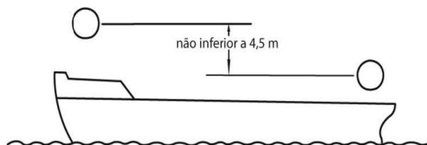
**Figura 107** - Navio de qualquer comprimento, fundeado, com dois faróis [Anexo I, 2.k)].
